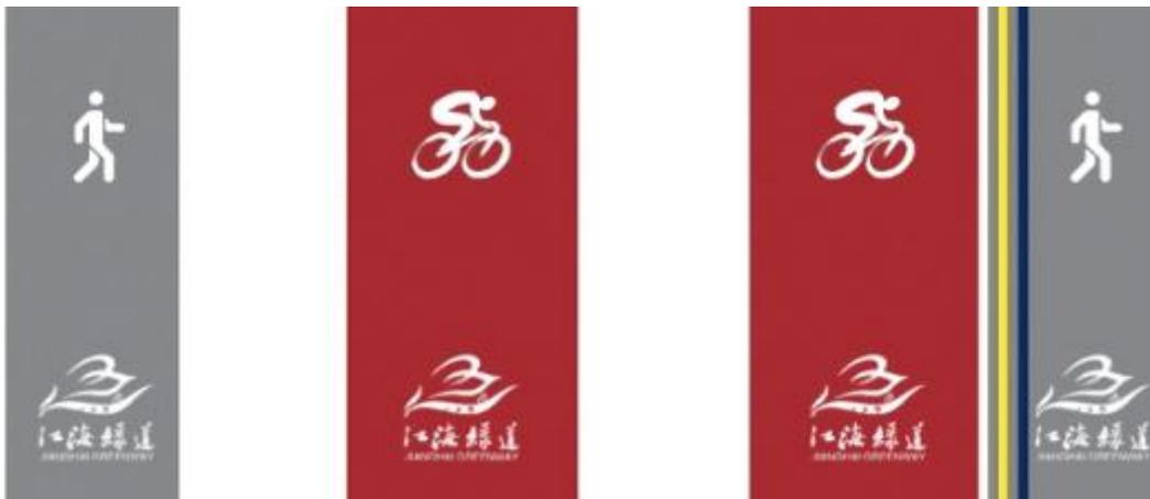
图5 绿道标志地面喷涂示意图（步行道、自行车道、综合游径）
